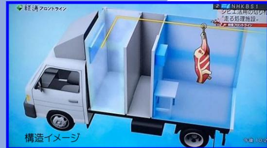
■「JA おおいがわ」で導入が検討されている「移動式解体処理車」(2トン車)。捕殺現場近くで内臓摘出、剥皮等の一次処理ができる。密閉冷蔵搬送により食肉の品質保持に役立つが何しろ高価格。導入時期も未定だ。
